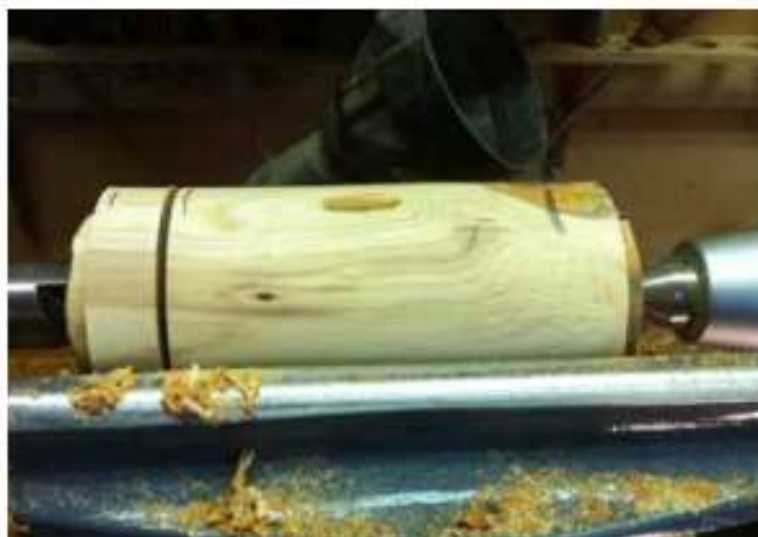
2. Het eerste stammetje voor het vaasje wordt tussen de centers opgespannen en aan beide einden wordt het uitsteeksel voor in de klauw gedraaid. Op ongeveer 20mm van het einde wordt een deel afgestoken wat later gebruikt wordt voor de bodem van het vaasje.
