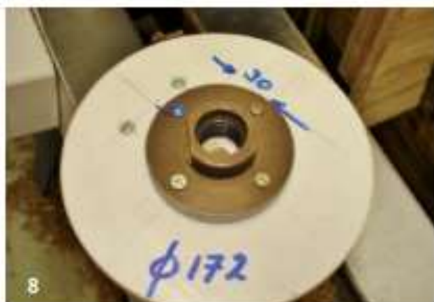
8. De hulpplaat met 't gaatje in het midden waarop de opspanplaat is geschroefd. Van de vier schroeven waarmee het kleine schijfje op de hulpplaat werd bevestigd zijn er twee te zien.
