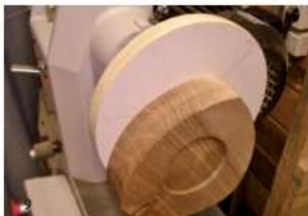
9. Een kleine schijf, excentrisch op de hulpplaat in de draaibank. De werkwijze tijdens het in vorm maken van de bovenkant en het uithollen is weer gelijk aan die van de grote schaal zoals eerder omschreven.
