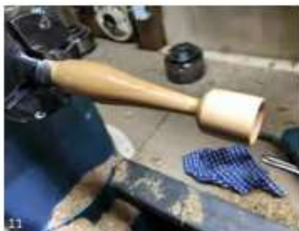
11. De steel in vorm gedraaid en afgewerkt met friction polish.
