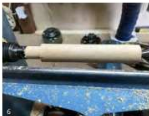
6. Links is aan het hout een pen \varnothing 20\text{mm} gedraaid om in het voetje te lijmen en om op te spannen in de klauwplaat. Later wordt de pen op juiste lengte afgestoken.
