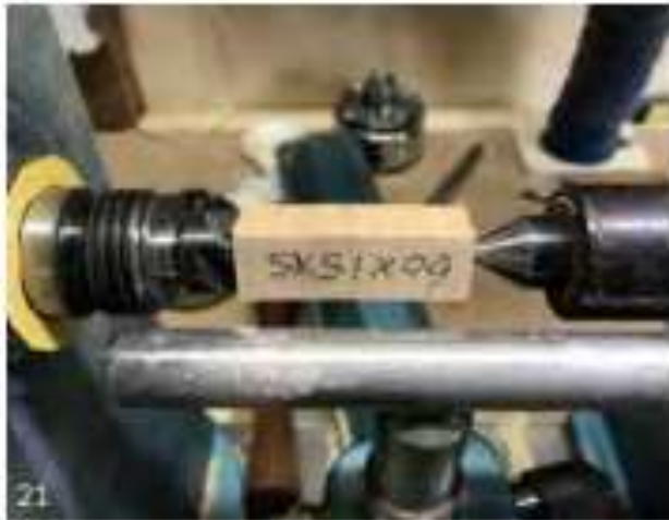
21. Het houtje voor het steeltje op het tolletje is tussen de centers opgespannen.
