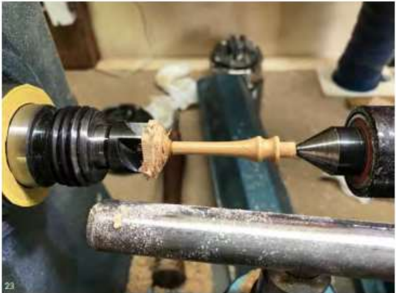
23. De vorm van het steeltje is af en kan afgestoken worden. De toren wordt nu in het voetje gelijmd en het steeltje in het tolletje. Gebruik houtlijm en geen secondenlijm.
