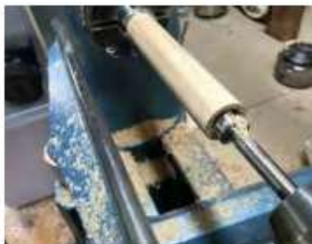
7. Als het hout voor de toren zuiver in de klauwplaat zit wordt een gat geboord van \varnothing 20\text{mm} , diep 2 à 3mm. Met een klein beiteltje wordt de bodem van het gat mooi vlak gedraaid zodat het puntje van de boor weg is.
