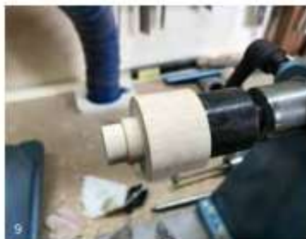
9. Hier heb ik een hulpstuk gedraaid dat strak op het tegencentre past en in het gat van de steel.
