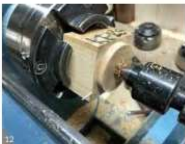
12. Het stukje hout voor de tol opgespannen in de klauwplaat waaraan een pen voor in de klauwplaat wordt gedraaid.
