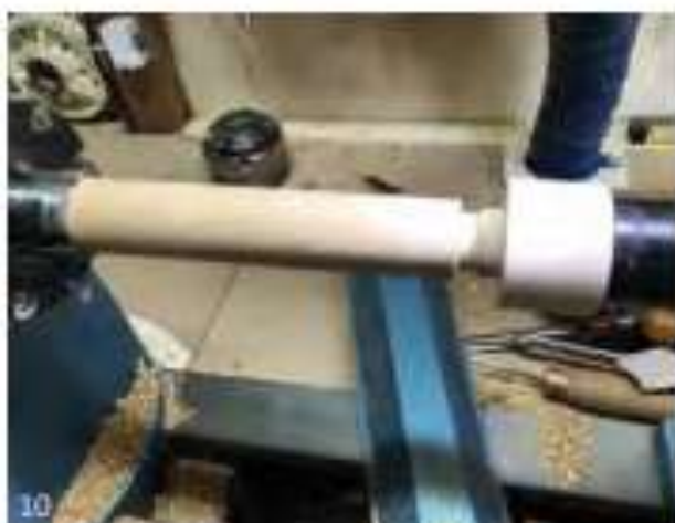
10. De steel in de klauwplaat en met het hulpstuk op het tegencentre. Nu kan de vorm van de steel gedraaid worden.
