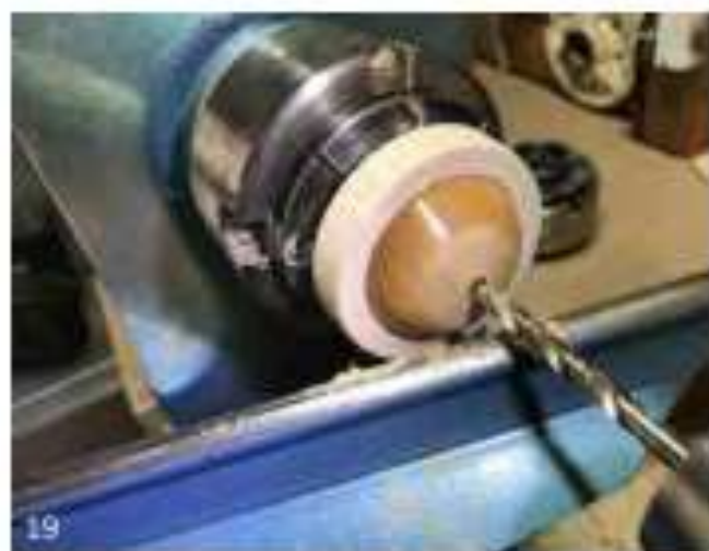
19. Het tolletje is in het hulpstuk geklemd en ik boor een gaatje voor het steeltje op het tolletje, \varnothing 6\text{mm} .
