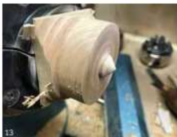
13. Het hout omdraaien en het puntje voor de tol draaien, \varnothing 12\text{mm} , lang \varnothing 10\text{mm} .
