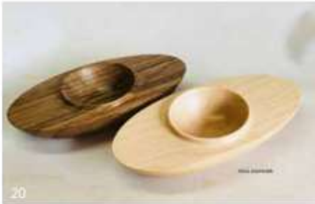
20. De 2 schaaltjes zijn afgewerkt met sanding sealer (grondlak), Danish oil en microcrystalline-wax
